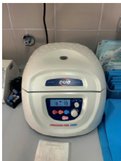
Slika 3. Centrifuga podešena na 1300 okretaja u 14 minuta.
